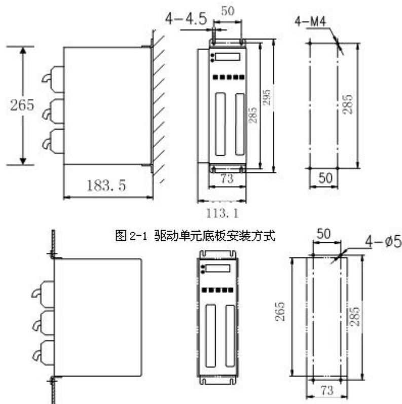
图 2-1 驱动单元底板安装方式
