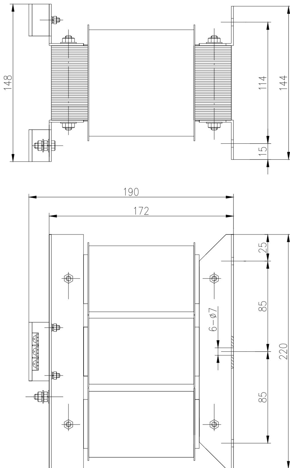
图 8-6 BS—200 型外形与安装尺寸图
