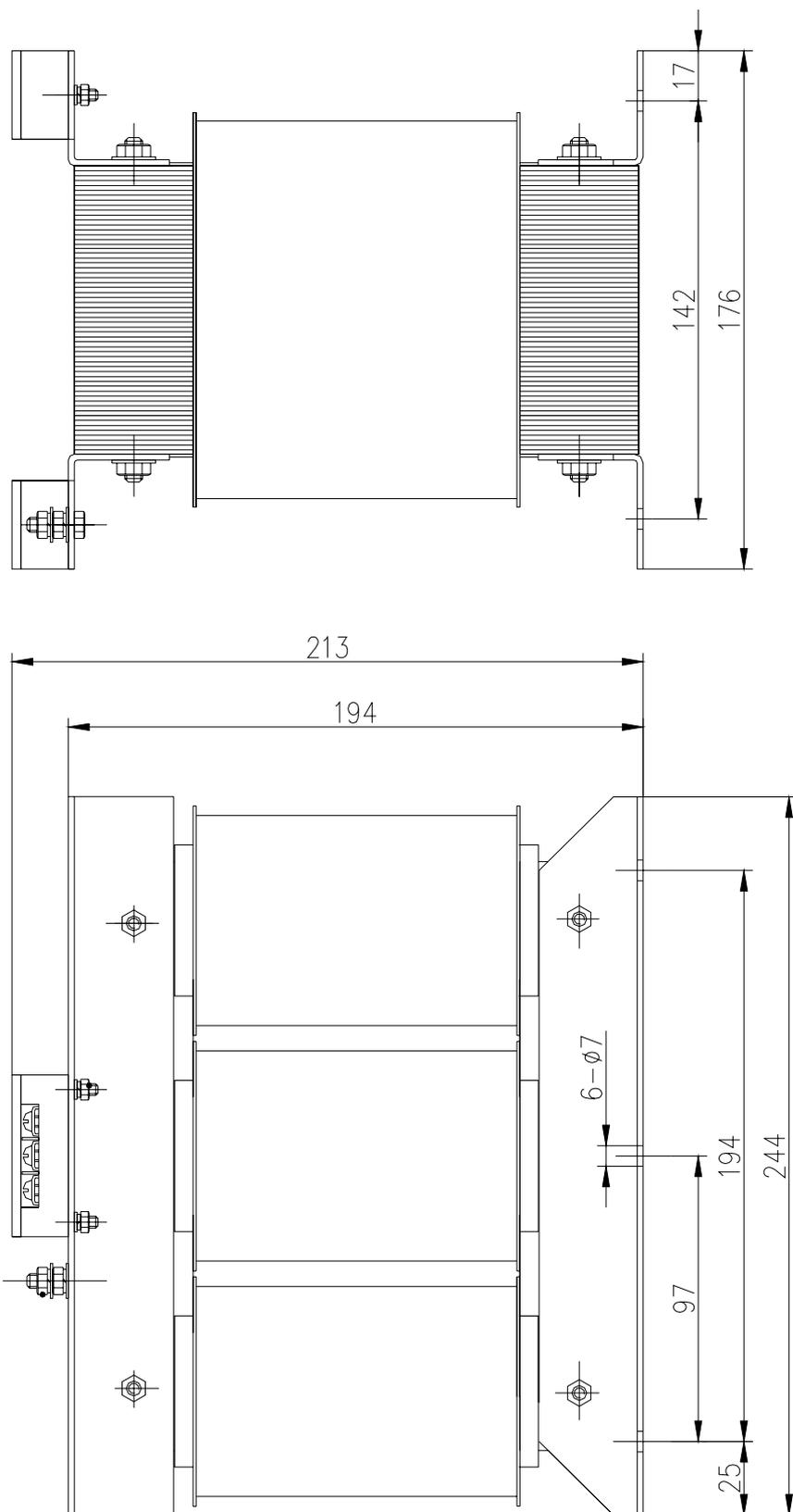
图 8-7 BS—300 型外形与安装尺寸图
