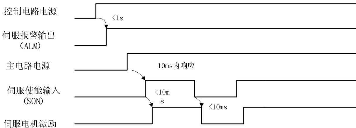
图 7-2 电源接通时序图
