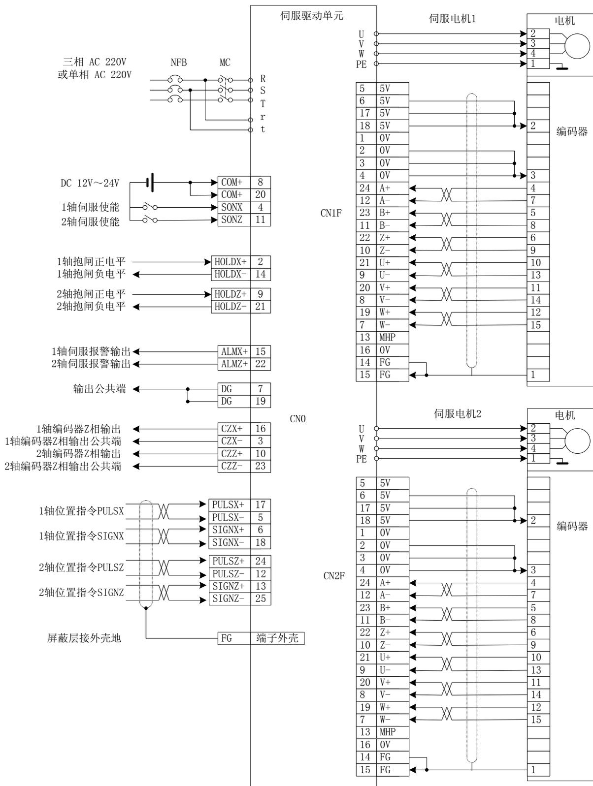
图 3-1 位置控制方式标准接线
