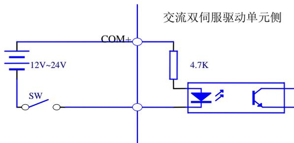
图 3-4 Type1 开关量输入接口
