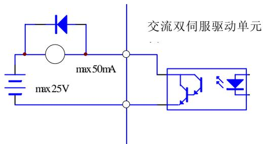
图 3-5 Type2 开关量输出接口
