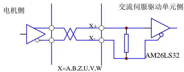
图 3-10 伺服电机光电编码器输入接口
