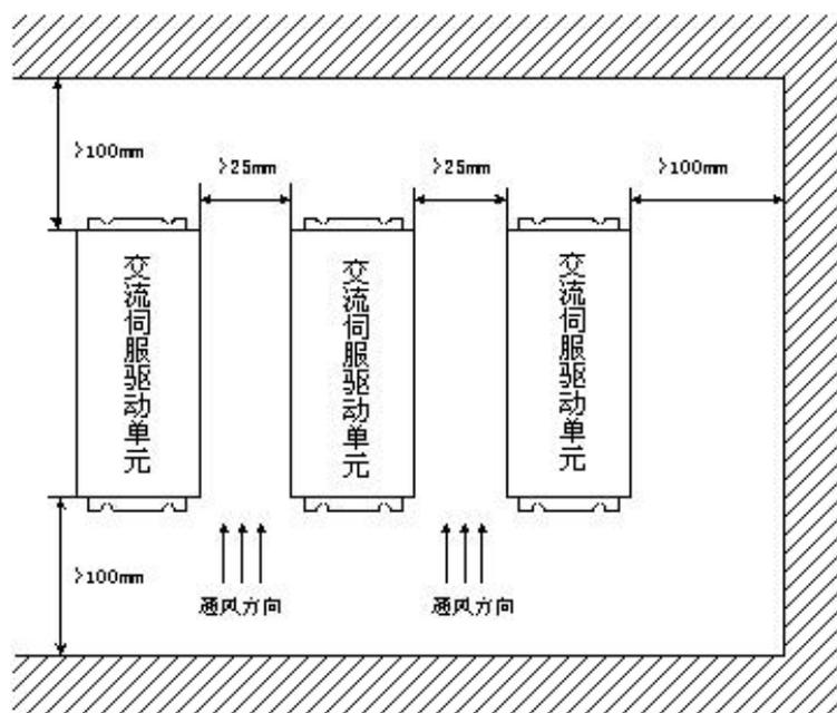
图 2-4 多台交流双伺服驱动单元安装间隔
