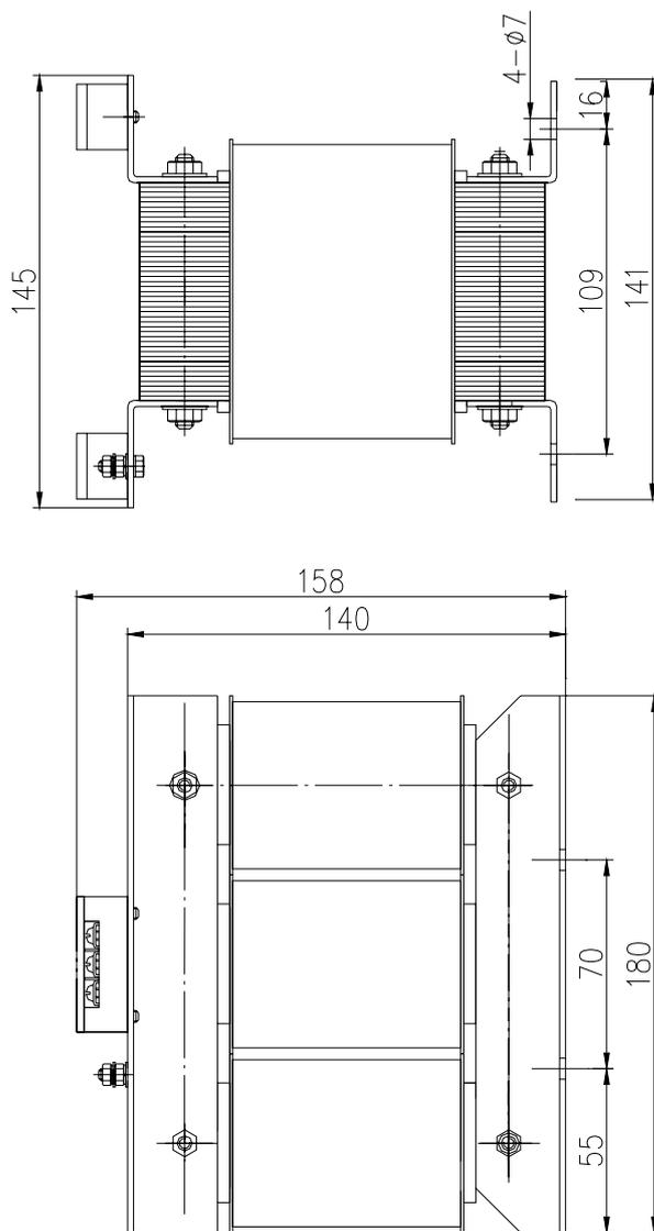
图 8-5 BS—120 型外形与安装尺寸图
