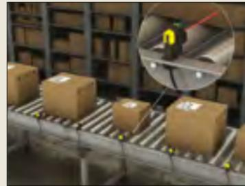
① 输送线中货物有无的检测
