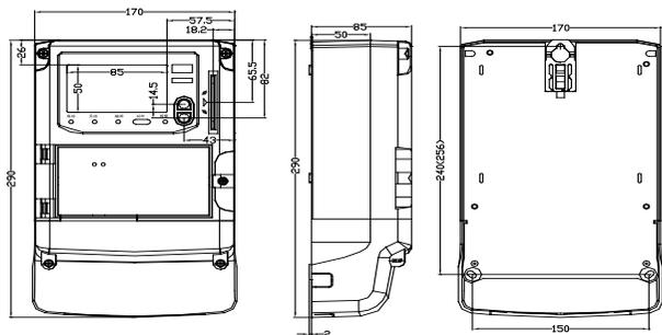
图 1: 安装尺寸图
