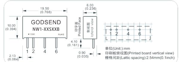
注意: 模块电源的各管脚定义如与选型手册不符, 应以实物标签上的标注为准。图中标注管脚长度为最小规格尺寸。
